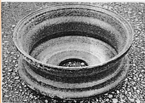
写真3.7 アルミニウム合金製ホイールの製造工程サンプル
