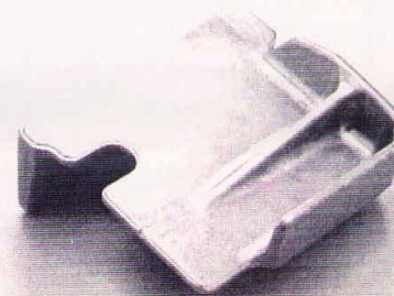
恒温鍛造製品 (Ti-10-2-3)
