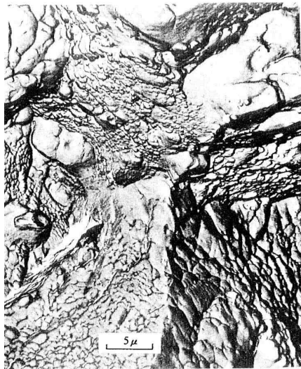
(a) レプリカ写真 (2219 アルミニウム合金, Pelloux 37 )
