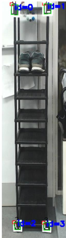
図 3.3 靴箱に設置した ArUco マーカの検出例
