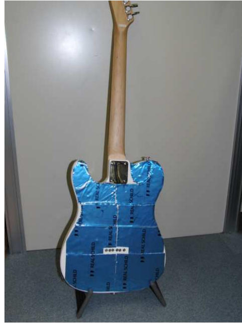
図 4.2 制振シートを貼 り付けたギター (裏)
