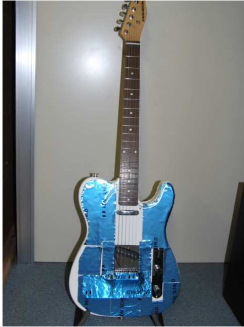
図 4.1 制振シートを貼 り付けたギター (正面)
