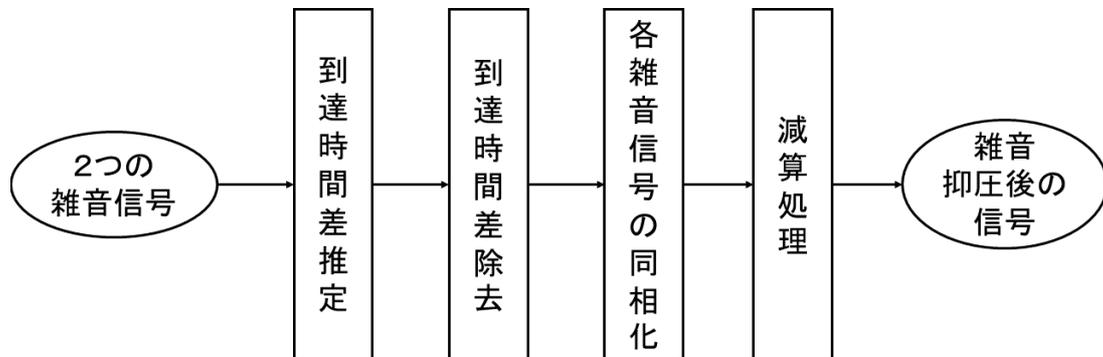
図 3.3 雑音抑圧処理の構成
