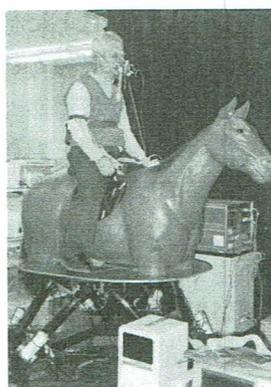
図1a 平行ロボットを用いた、乗馬療法の健康増進メカニズムの解明
