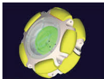
写真1 歩行王（あるきんぐ）の駆動部に使われるオムニホイール http://www.satt-web.com/omniwheel.htm
